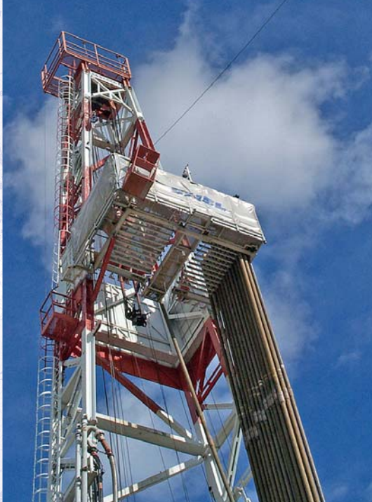
▲ Machine de forage permettant la réalisation de puits à de grandes profondeurs jusqu'à 5 000 mètres.
