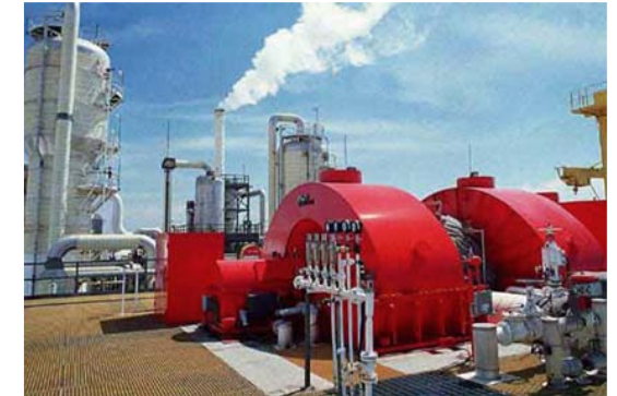
Unité de production d'électricité géothermale par turbine à l'Imperial Valley en Californie.
