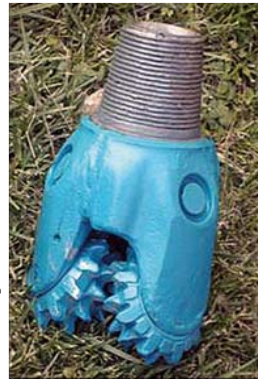
▶ Trépan utilisé pour le forage géothermique.
