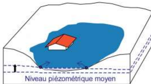
Inondation par remontée de nappe phréatique
